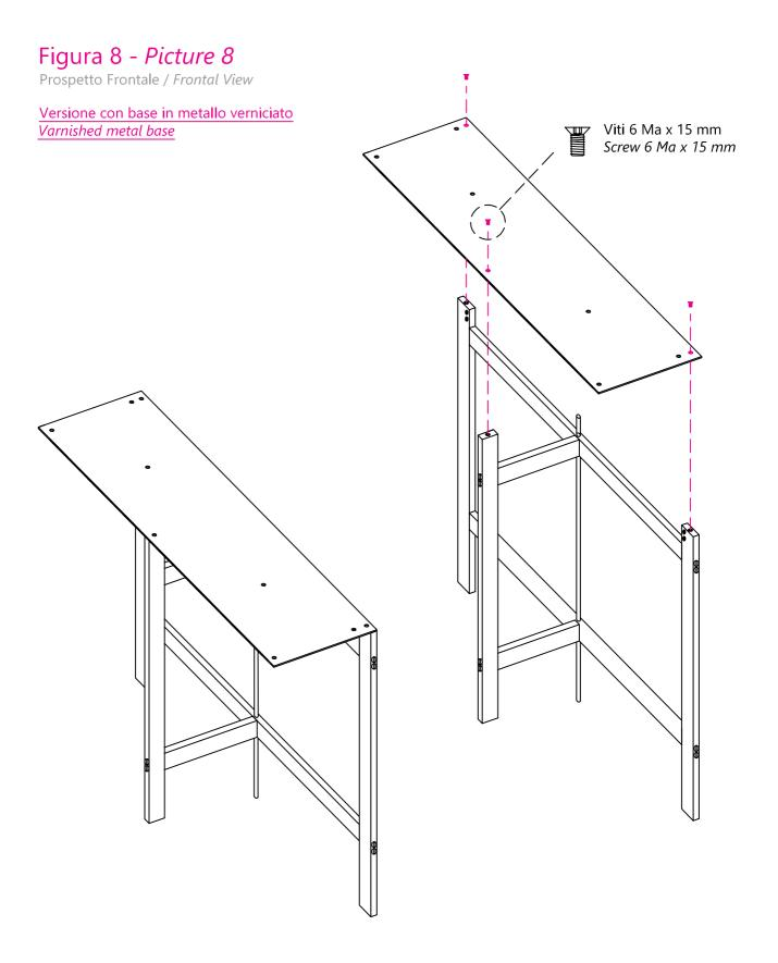
Assemblaggio di una gamba completato, ripetere lo stesso procedimento per la seconda. The assembly of one leg is completed. Repeat all steps for the second leg.
