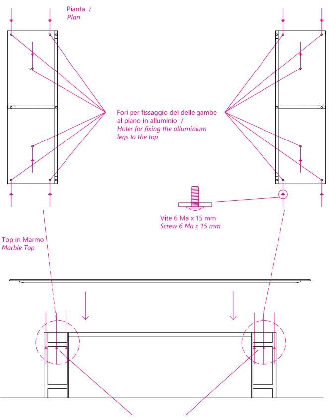
Viti 6ma x 15mm nera testa piatta con rondella Ø 25 mm nera. Screw 6ma x 15mm black flat head with black washer 25 mm.
