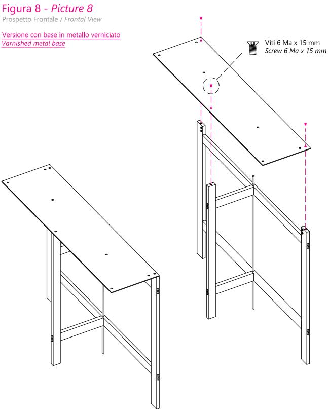
Assemblaggio di una gamba completato, ripetere lo stesso procedimento per la seconda. The assembly of one leg is completed. Repeat all steps for the second leg.
